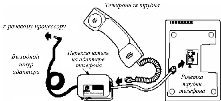
Рис 13. Установка телефонного адаптера
