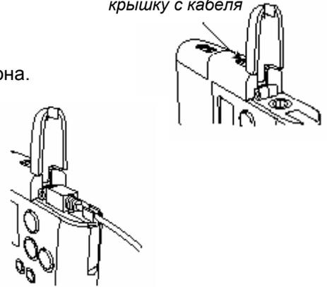
Когда Вы снимаете или настраиваете речевой процессор, может быть, Вам захочется отсоединить головной телефон от процессора. Чтобы сделать это, выньте вилку кабеля головного телефона из процессора. Оставьте вилку кабеля головного телефона в гнезде микрофона.
