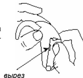
3. Вставьте передающий кабель (B) в гнездо в верхней части корпуса микрофона.
